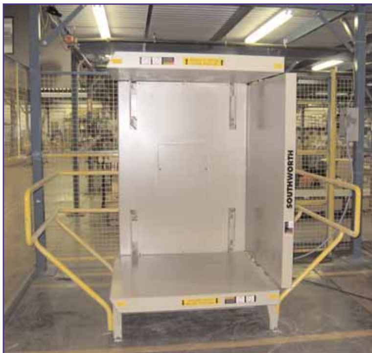
Le retourneur/inverseur PalletPal prend approximativement une minute pour terminer un cycle complet (180 degrés)
